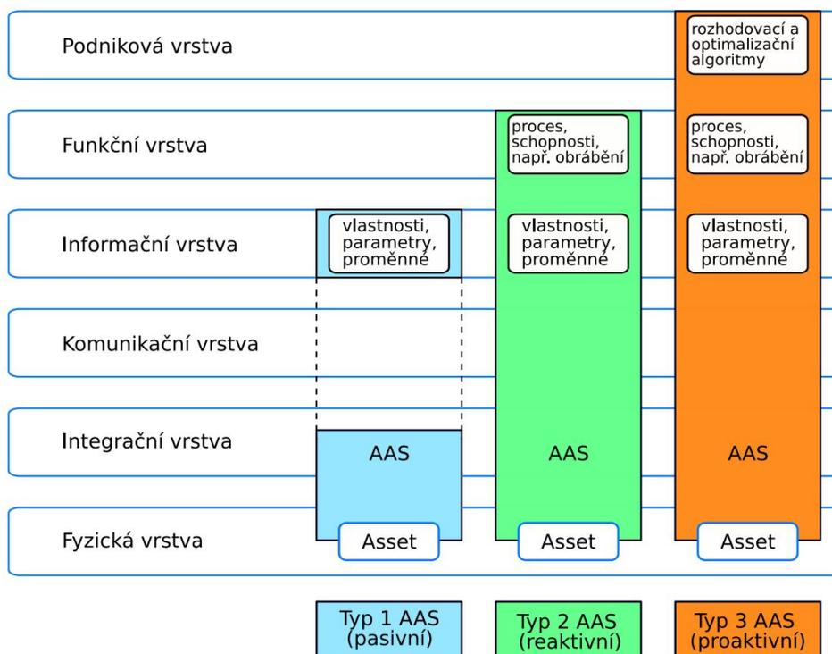
Obr. 1.9: Srovnání interakčních typů AAS pomocí RAMI 4.0 [36]
