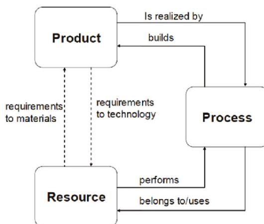
Obr. 1.13: Model produkt-proces-zdroje [11]
