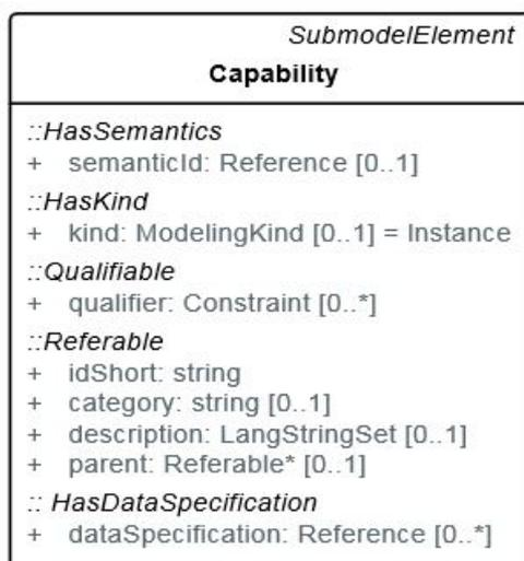
Obr. 1.14: Model elementu výrobní schopnosti v AAS [41]
