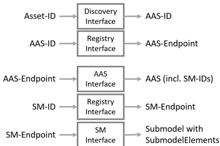
Obr. 1.10: Funkce pro prohledávání AAS pomocí identifikátorů (po získání Asset-ID nebo AAS-ID postupně od shora) [43]
