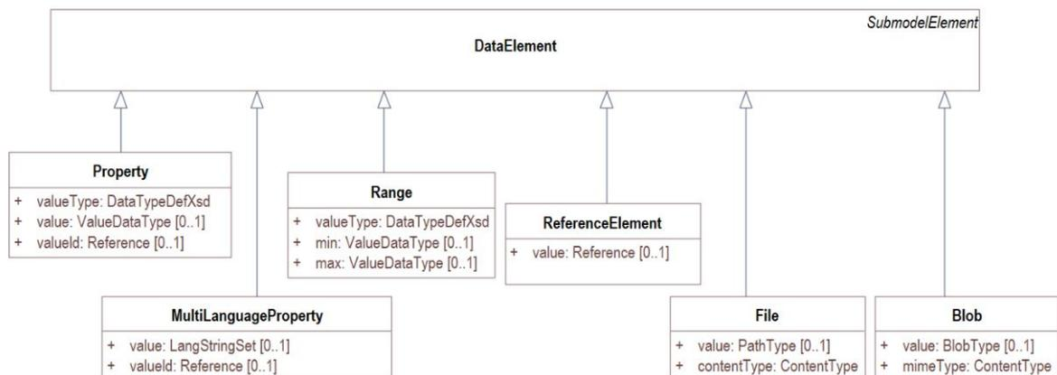
Obr. 1.12: Metamodel datového elementu [47]
