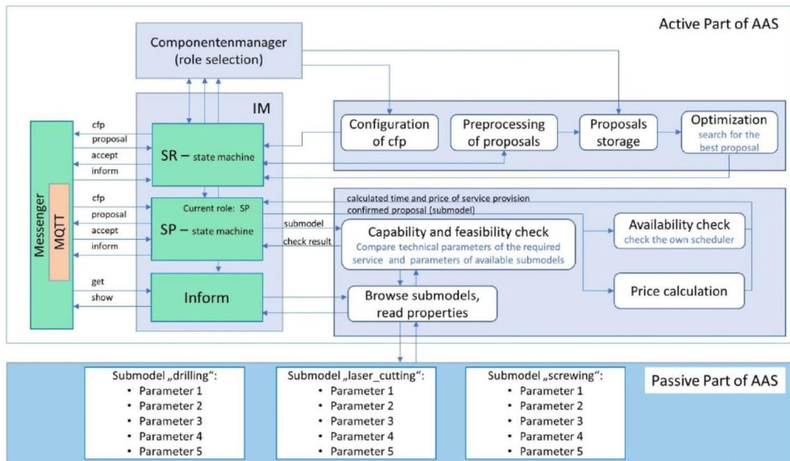
Obr. 1.18: Příklad architektury AAS s vyjednávacím algoritmem [4]
