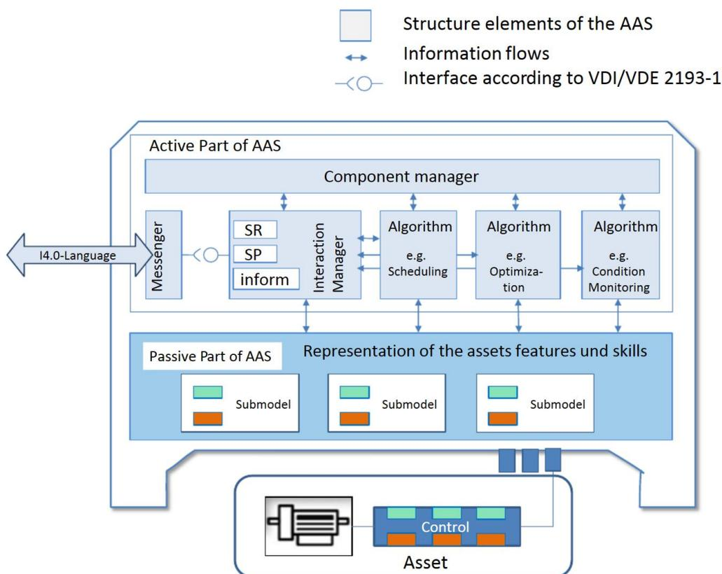
Obr. 1.8: Struktura proaktivního AAS [4]
