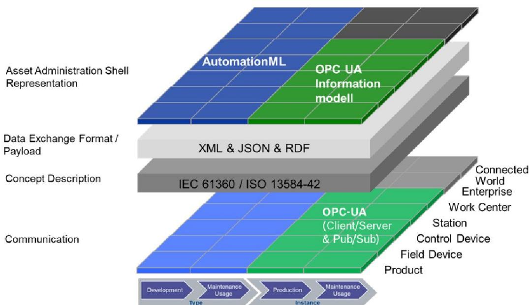
Obr. 1.16: Použití AutomationML a OPC UA v informační vrstvě AAS [47]
