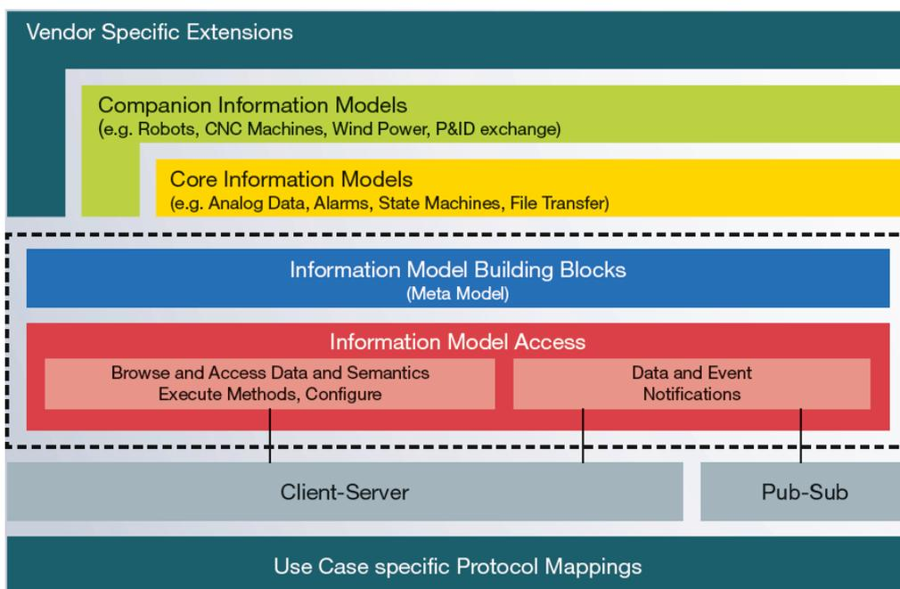
Obr. 1.4: Architektura technologie OPC UA [33]
